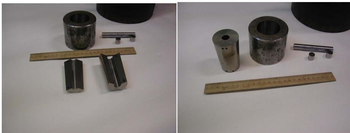
Рис. 2.1 Разъёмная цилиндрическая матрица диаметром 13,6 мм в разобранном (а) и собранном (б) состоянии.
