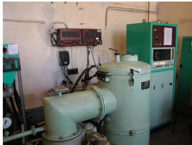
Рис 2.3. Вакуумная печь СШВ-1,25/24-И1: а – схема, б – общий вид, в – расположение печи, программатора и прибора ВАРТА с терморегулятором ТП703.
